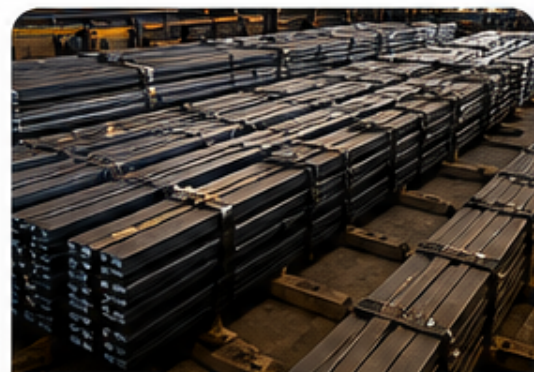
تسمه‌های آلیاژی فنر (فنر تخت خودرو) 55Cr3 / 51CrV4
